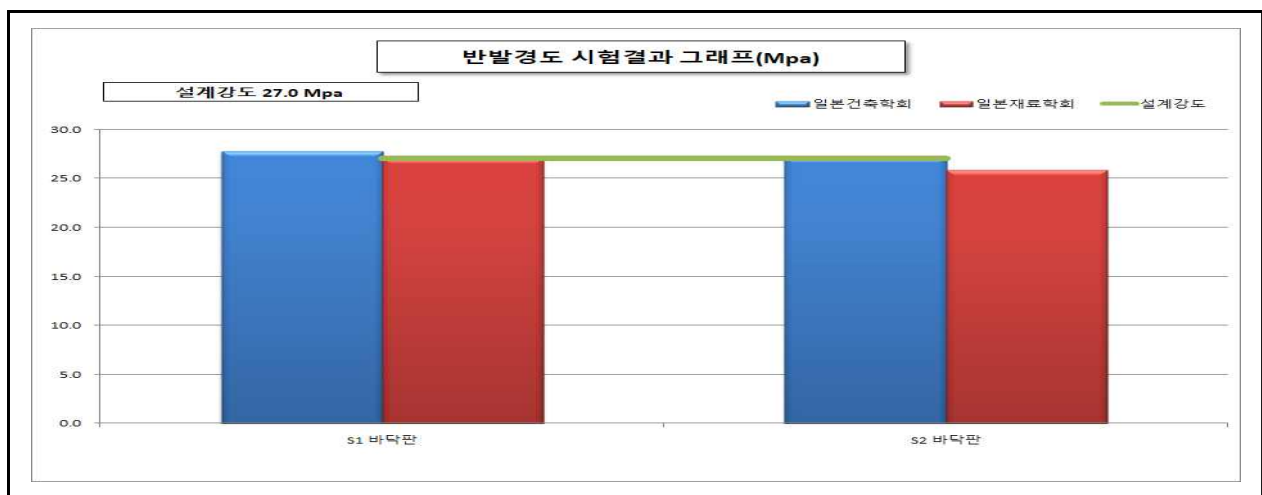
【그림 1.4.5】 영천방향 상부구조 반발경도시험 측정결과
